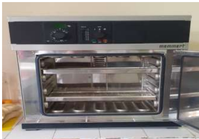
Figure III.6 : Photo de l'étuve utilisée pour le séchage.
