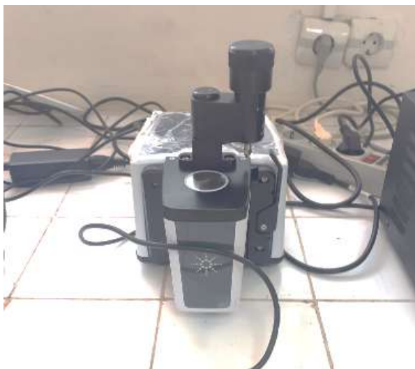
Figure III.10 : Spectromètre ATR de type Agilent Cary 630 FTIR.
