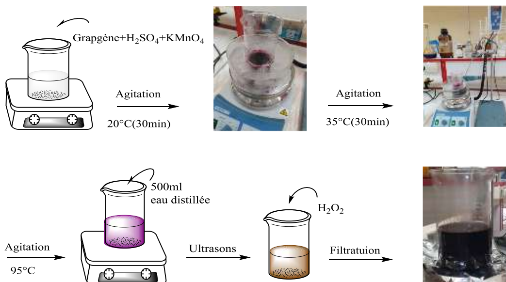
Figure IV.4 : Etapes de synthèse de l'OG par la méthode d'Hummers modifiée.
