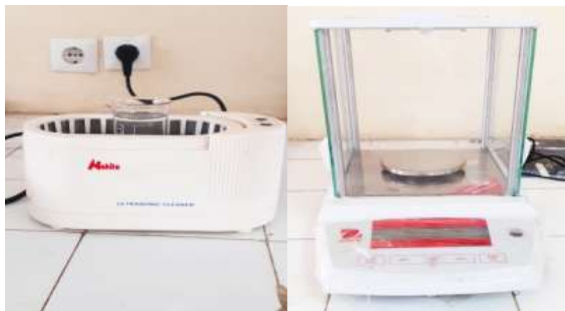
Figure III.7 : L'appareille à Ultrasons et balance analytique utilisés
