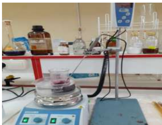
Figure III.2 : Montage de synthèse de l'OGr par la méthode d'Hummers.
