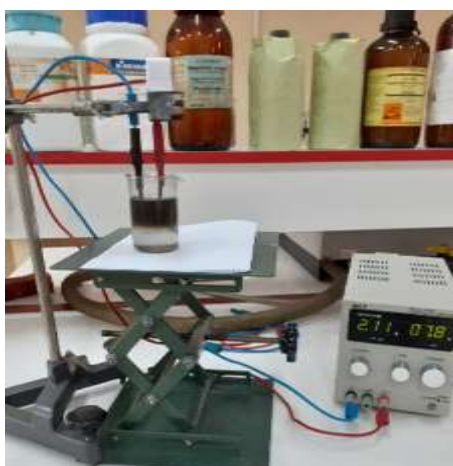
Figure IV.2 : Montage de la synthèse électrochimique de l'oxyde de graphène réduit (OGr).
