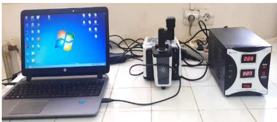
Figure III.8 : Appareille la spectroscopie infrarouge à transformé de Fourier (FTIR).
