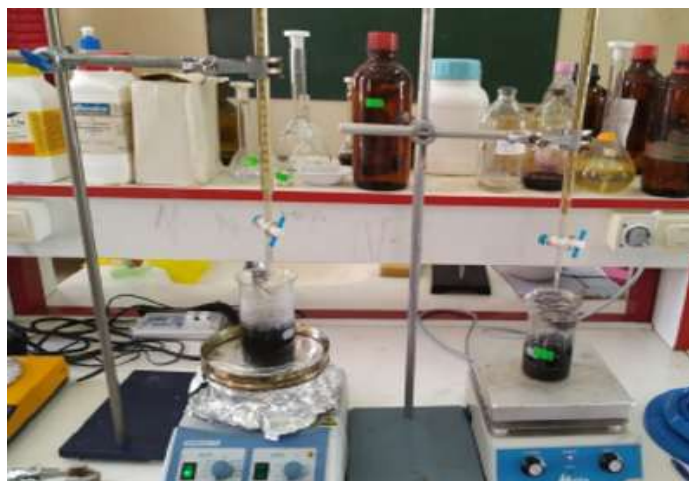
Figure III.4 : Montage de synthèse chimique des composites de graphène et d'OGr.
