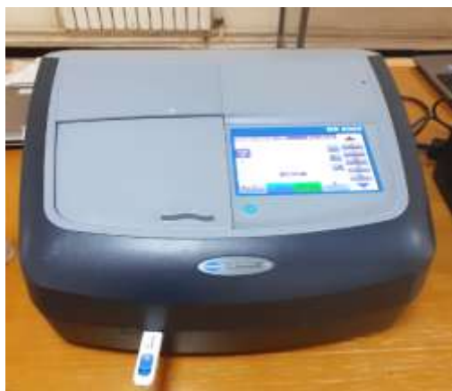
Figure III.12 : Spectromètre UV-Visible de type LANGE DR 6000.
