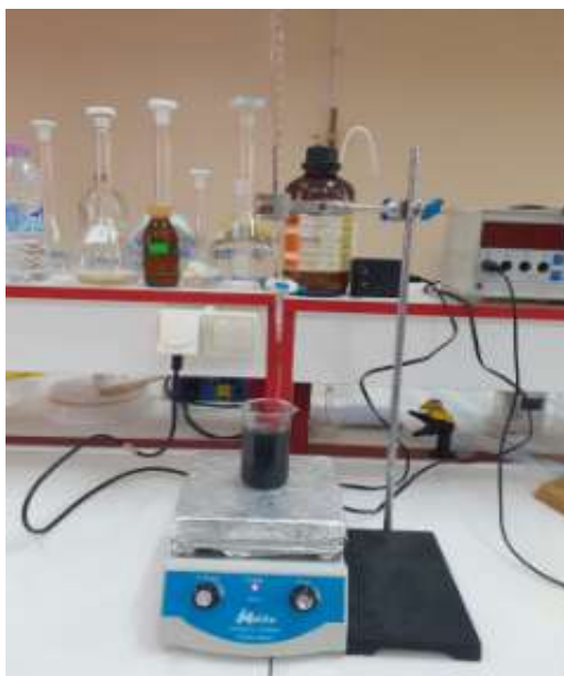
Figure IV.7 : Montage de réduction de l'OG par l'hydrazine.
