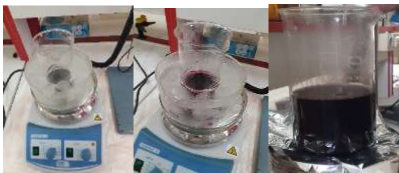
Figure IV.5 : Variation de la couleur de la solution lors des étapes d'exfoliation chimique.
