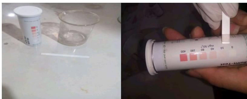
**Photographie III.10** : Test de détermination du  $SO_3^{2-}$ .
