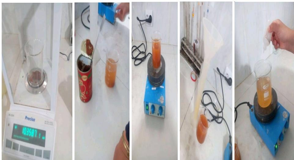
**Photographie III.7 :** Détermination de l'acidité.
