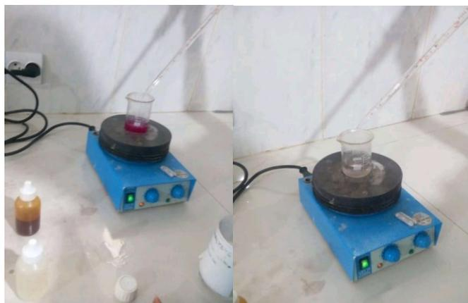
**Photographie III.11** : Détermination du (TA) des eaux de chaudière.
