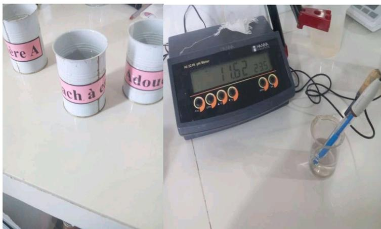
**Photographie III.9** : Mesure du pH des eaux de chaudières.
