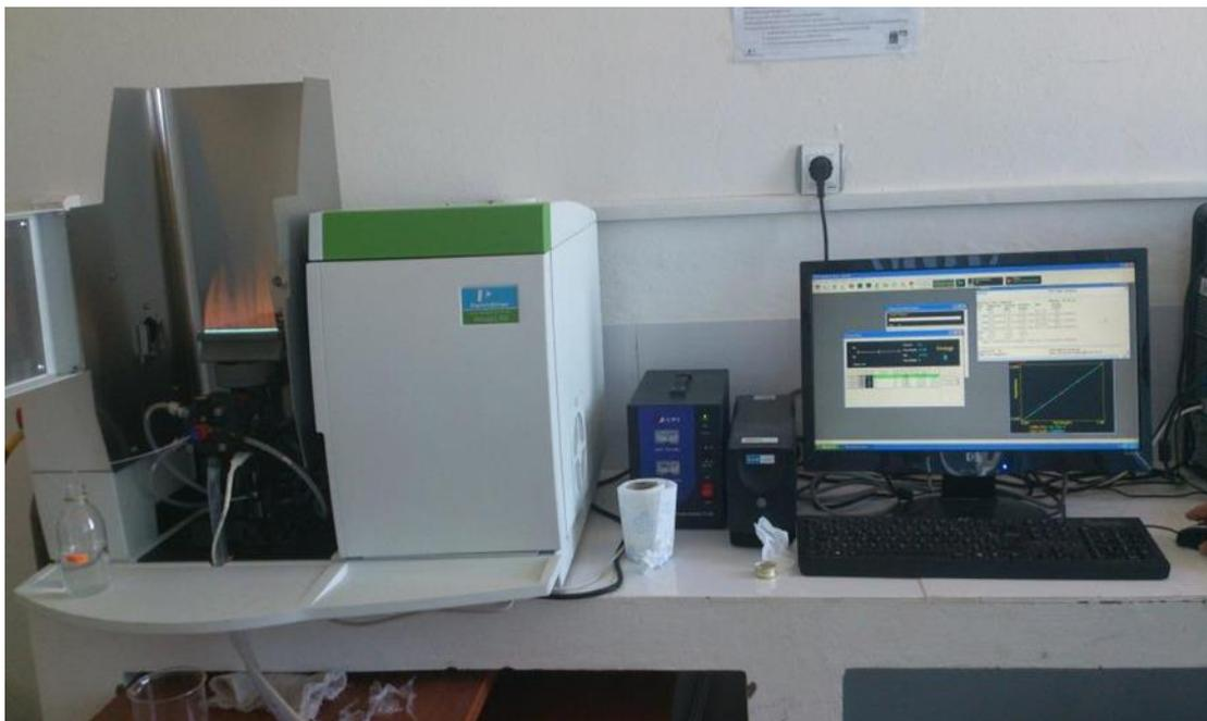
**Figure III.10** : Spectrophotomètre d'absorption atomique AAnalyst 400 Perkin Elmer (L.A.I.G.M).
