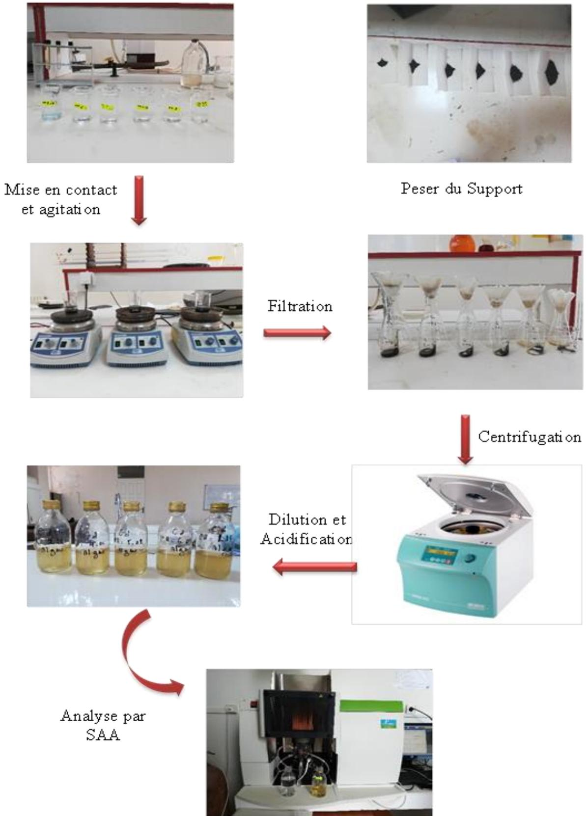
Figure III.8: Procédé expérimental de l'adsorption (batch).
