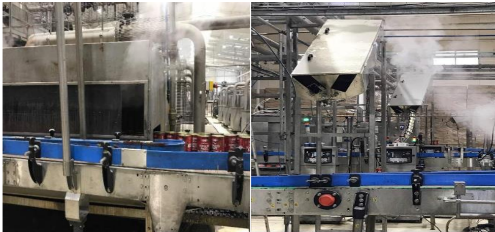
Figure II.11: Stérilisation et refroidissement.
