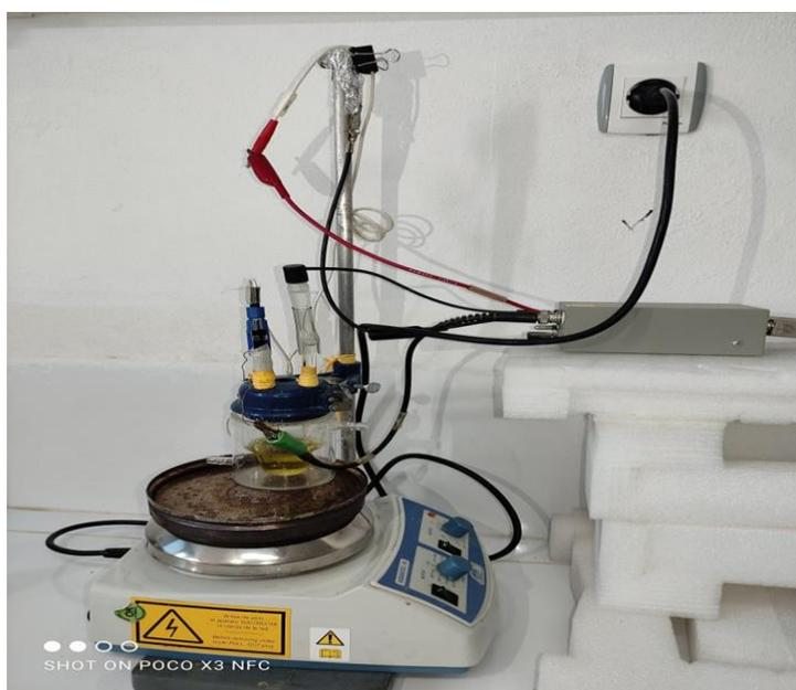
Figure III.1: Montage expérimental utilisé pour l'électrodéposition du fer, nickel et nickel-fer.
