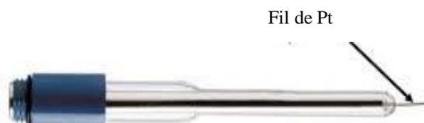
*Figure III.3:* Electrode auxiliaire en platine.
