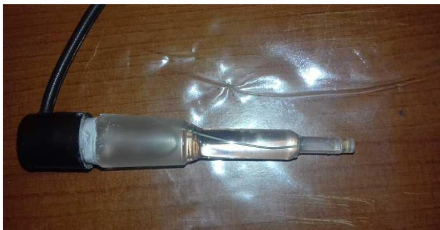
*Figure III.2:* Photo de l'électrode de référence Ag/AgCl utilisée dans la partie expérimentale.
