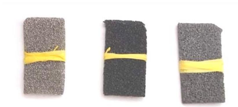
**Figure III.4:** Photo des trois mousses utilisées pour l'électrodéposition du Ni et/ou Fe sur (de gauche à droite) mousse de nickel, mousse d'acier et mousse d'inconel.
