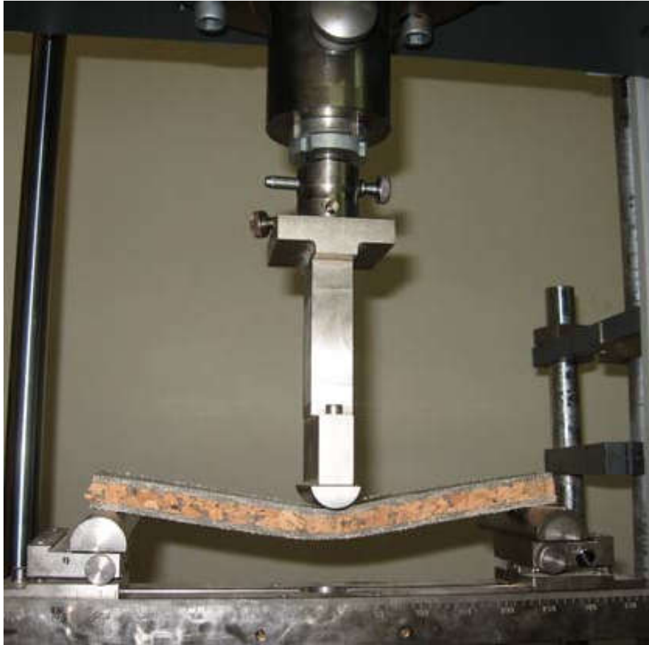
Figure 2.4 : Béton soumis à la flexion 3 points
