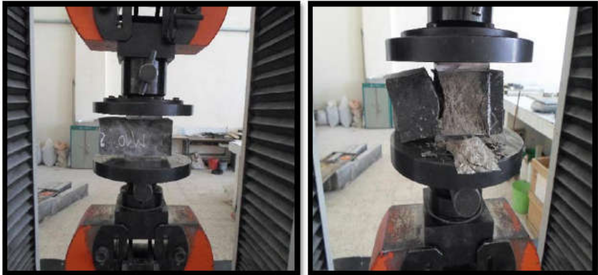
Figure 2.7: Mortier soumis à la compression pure
