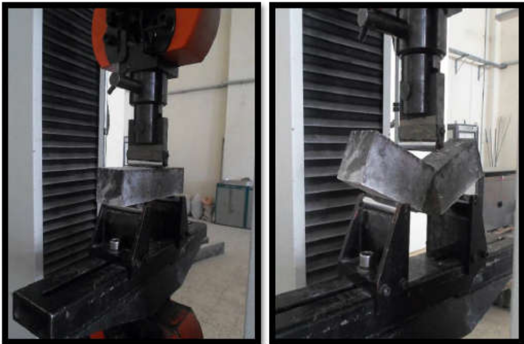
Figure 2.5: Mortier soumis à la flexion 3 points
