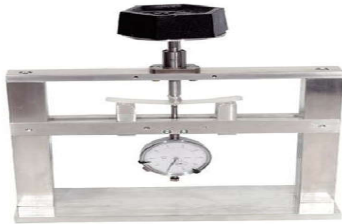
Figure 2.3 : Portiques pour essais de flexion
