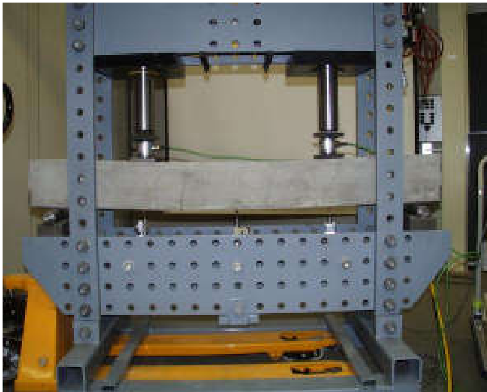
Figure 2.6 : essai de flexion de quatre points
