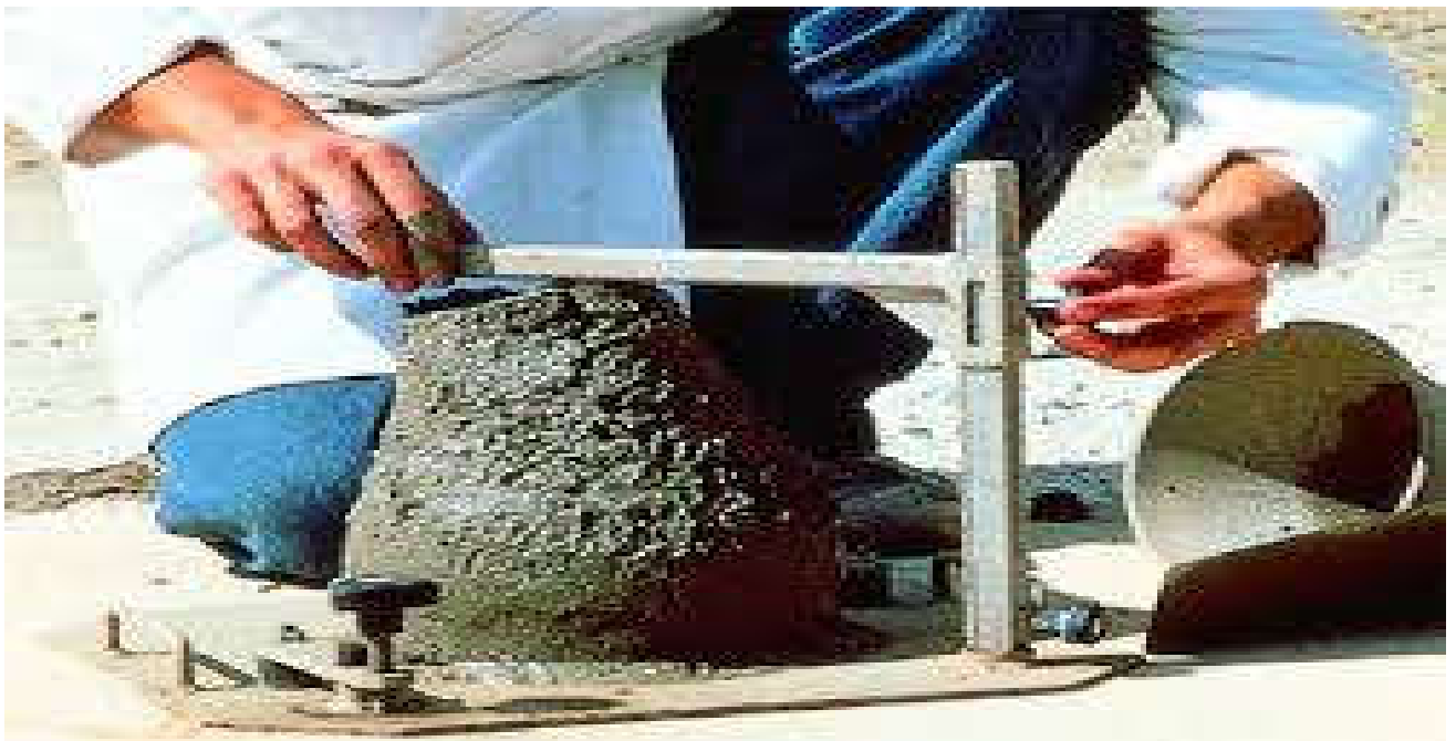
Figure 1.2 : mesure de l'affaissement au cône d'Abrams
