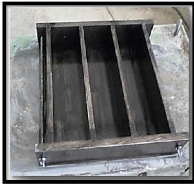
Figure 5.7: Moule de confection des éprouvettes 7×7×28 cm
