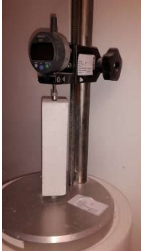
Figure 1.7: Appareillage pour la mesure du retrait
