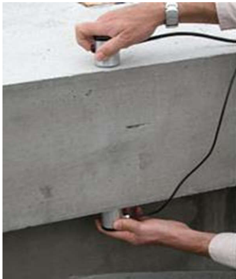
Figure 3.6 : essai ultrasonique sur une poutre.
