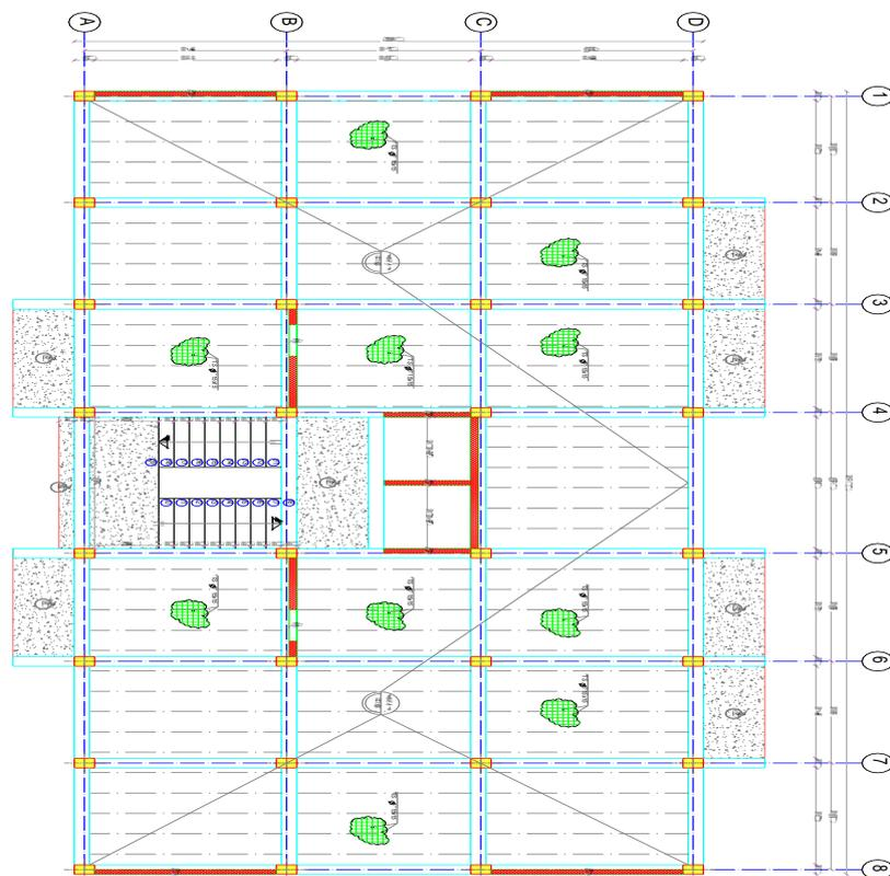
Figure 39: Plan de coffrage (Disposition des poutrelles)
