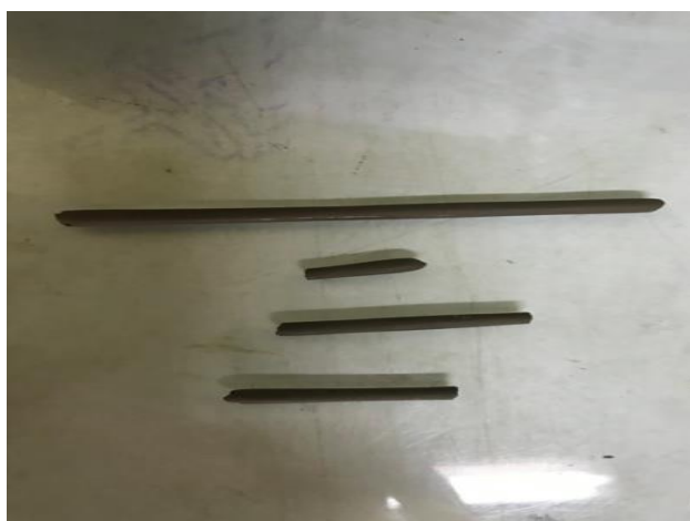
Figure 67: Détermination de la limite de plasticité
