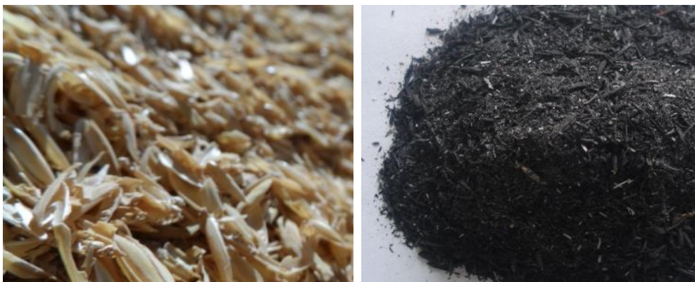
Figure 40: Balle de riz (à gauche) cendre de balle de riz (à droite)
