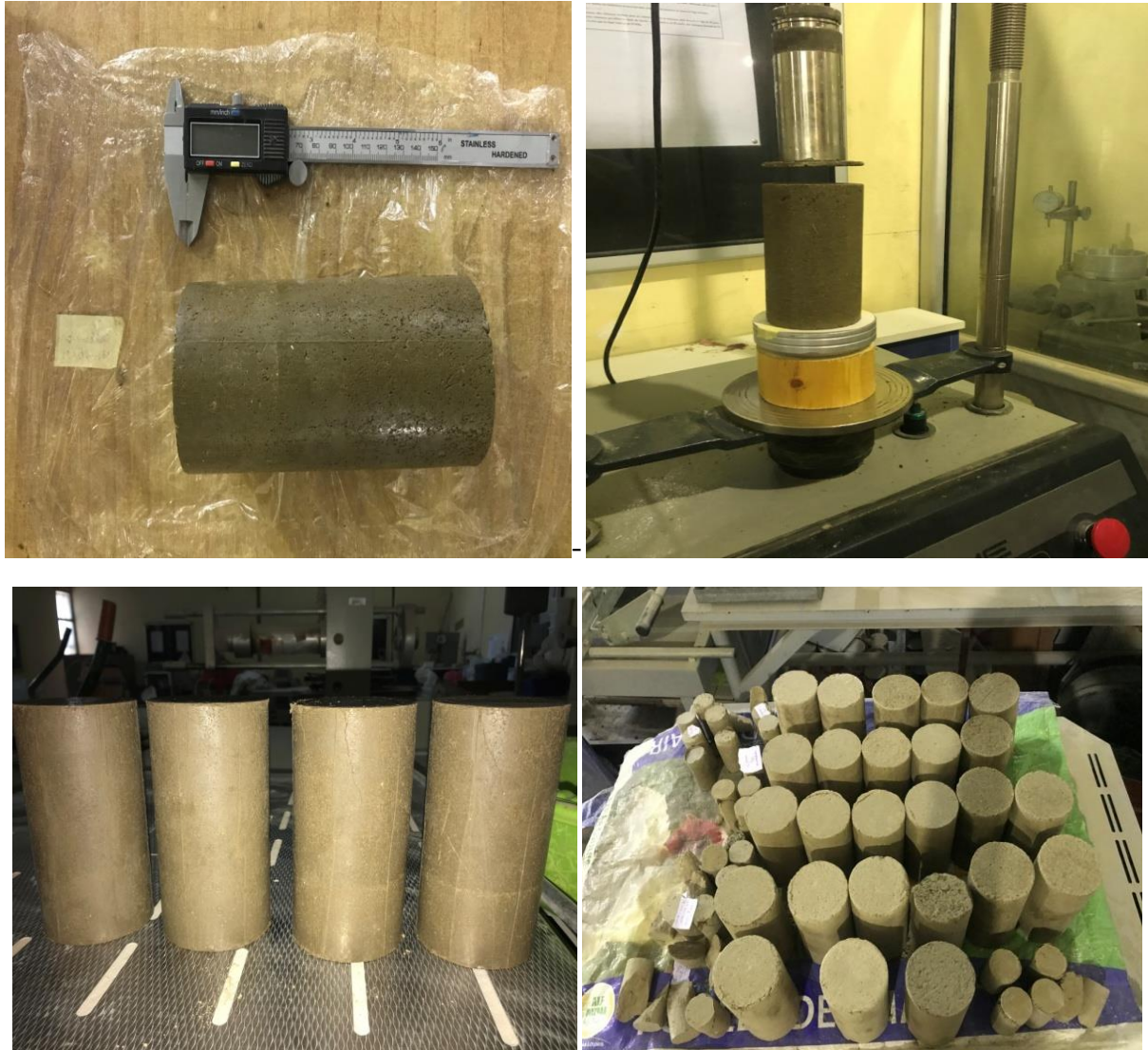
Figure 88: Photos représentant les diverses procédures de l'essai de compression simple
