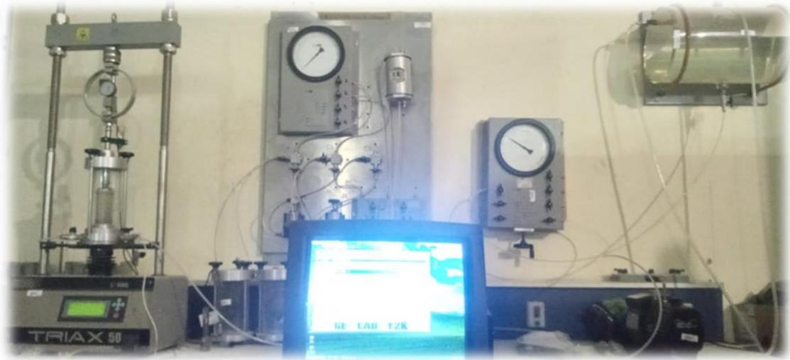
**Figure III.51.** Appareillage de l'essai triaxial.
