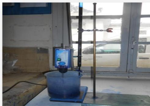
**Figure III.28.** L'appareillage nécessaire pour l'essai au bleu de méthylène.
