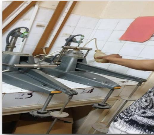
**Figure III.45.** Vue générale de l'appareil œdométrique.
