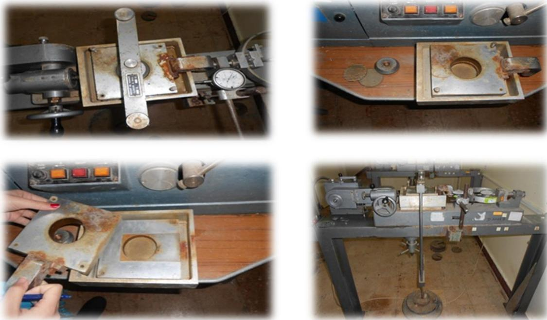
Figure III.39. Boite et l'appareil de Cisaillement.
