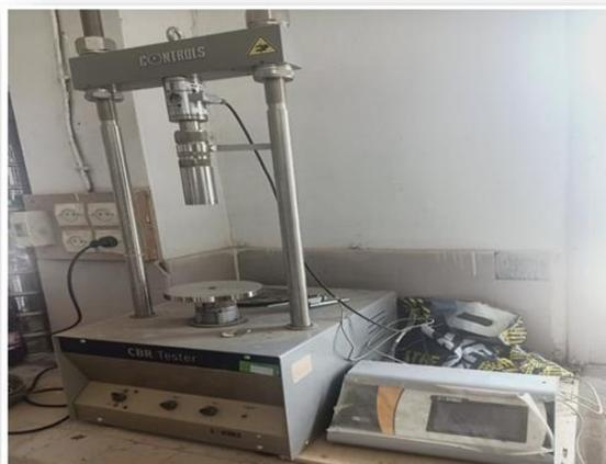
**Figure IV.70.** La machine de CBR utilisée pour la Compression simple au laboratoire (LTPE. Annaba).
