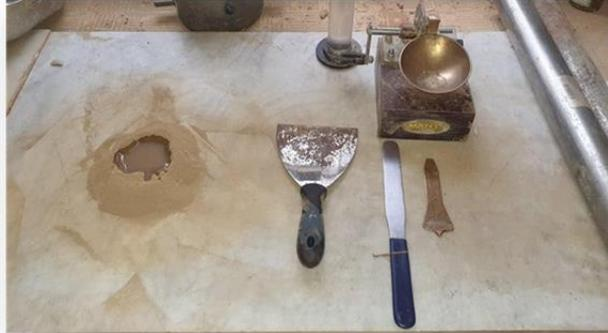
**Figure III.21.** Matériel utilisé dans l'essai de Limites d'Atterberg.
