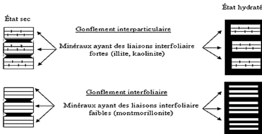
**Figure I.8.** Mécanismes de gonflement des argiles par hydratation. Bouzid. (1997) ; Bengraa (2004) et Gueddoudda (2005).
