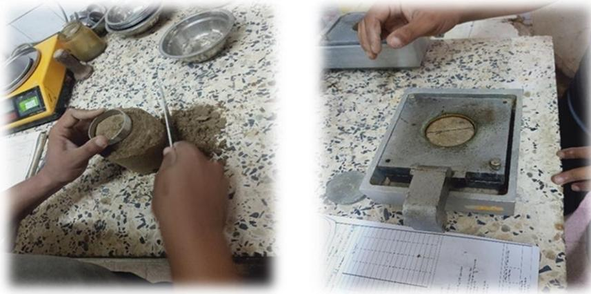
**Figure III.41.** Préparation de l'échantillon d'essai cisaillement laboratoire LTP-Est.
