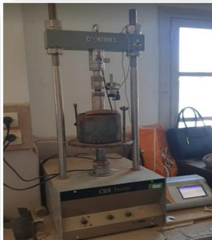
**Figure III.34.** L'appareil CBR.
