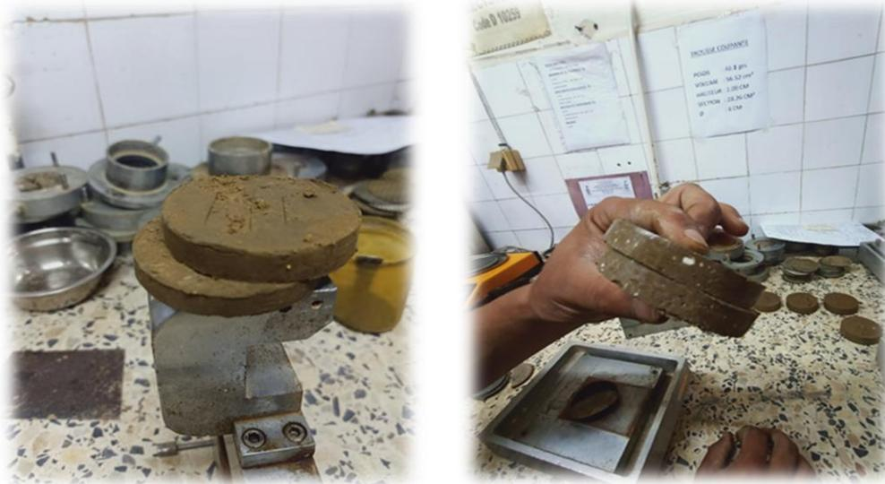
**Figure III.42.** L'échantillon après l'essai cisaillement, Laboratoire LTP-Est.
