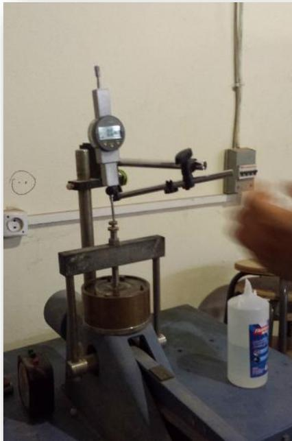
**Figure III.33.** Mesure de la pression de gonflement.
