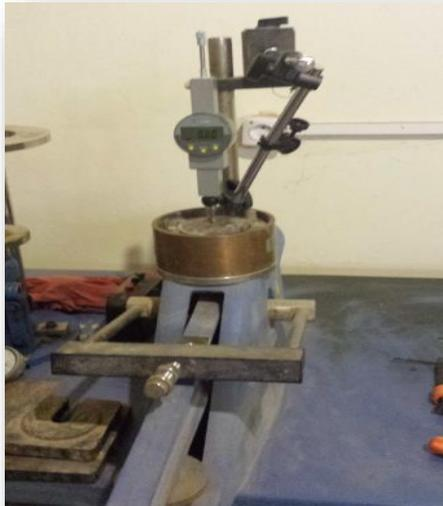
**Figure III.32.** Mesure du gonflement libre par l'oedomètre.
