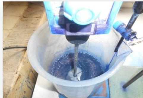
Figure III.29. Exécution de l'essai au bleu de méthylène.
