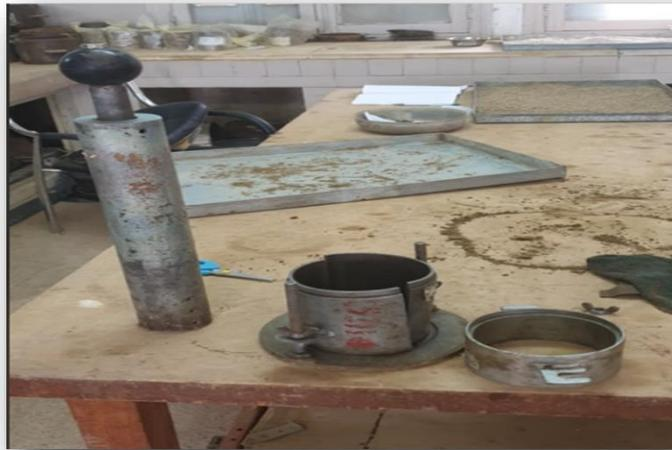
**Figure III.49.** Appareillage nécessaire pour l'essai Proctor.
