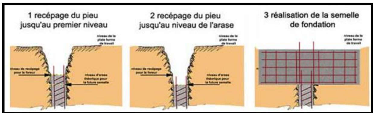
Figure II-31 : Différentes opérations effectuées lors du recépage des pieux
