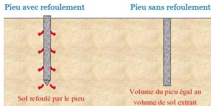
Figure II-13 : Les deux grands types de pieux [13]
