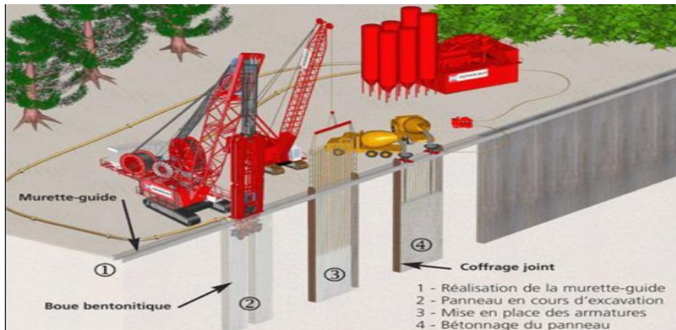
Figure II-22 : L'exécution d'une paroi moulée
