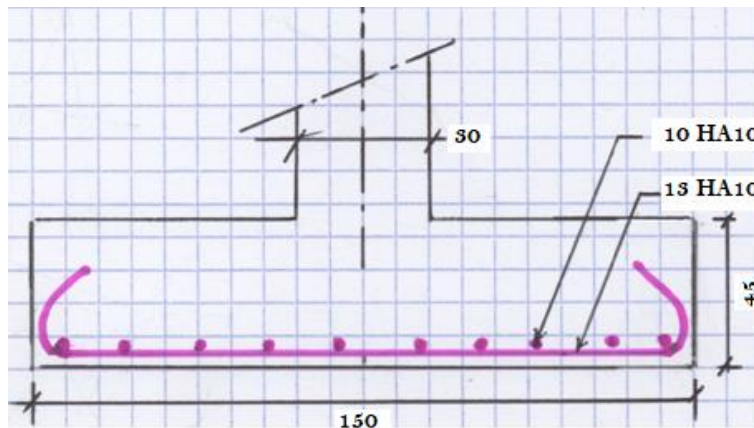
Figure V-7 : Schéma de ferrailage de la semelle selon les calculs du DTU 13.12
