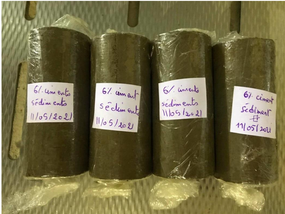
Figure 90 : Echantillons du sédiment traité par 6% Ciment
