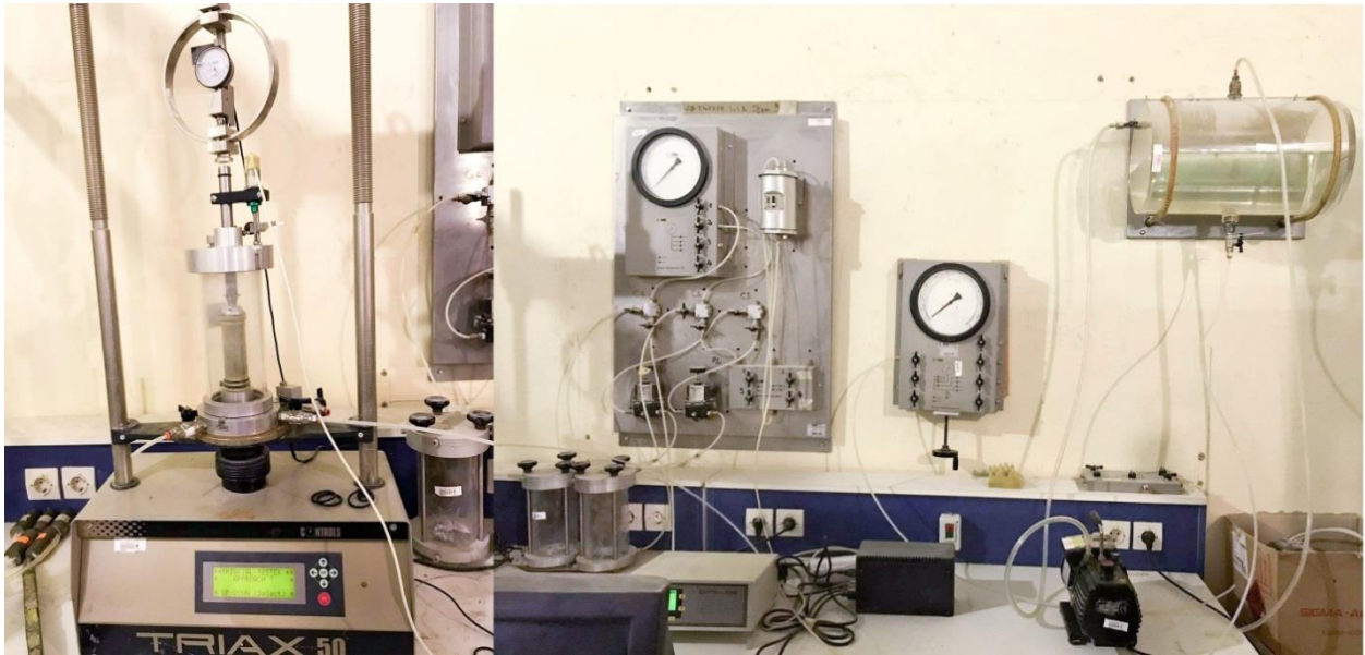
Figure 66 : Appareil triaxial du laboratoire (LGCH) Guelma
