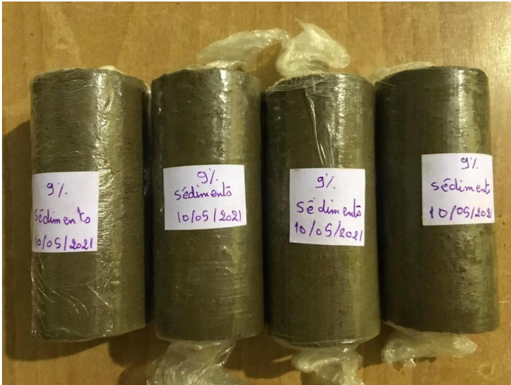
Figure 94 : Echantillons du sédiment traité par 9% Ciment
