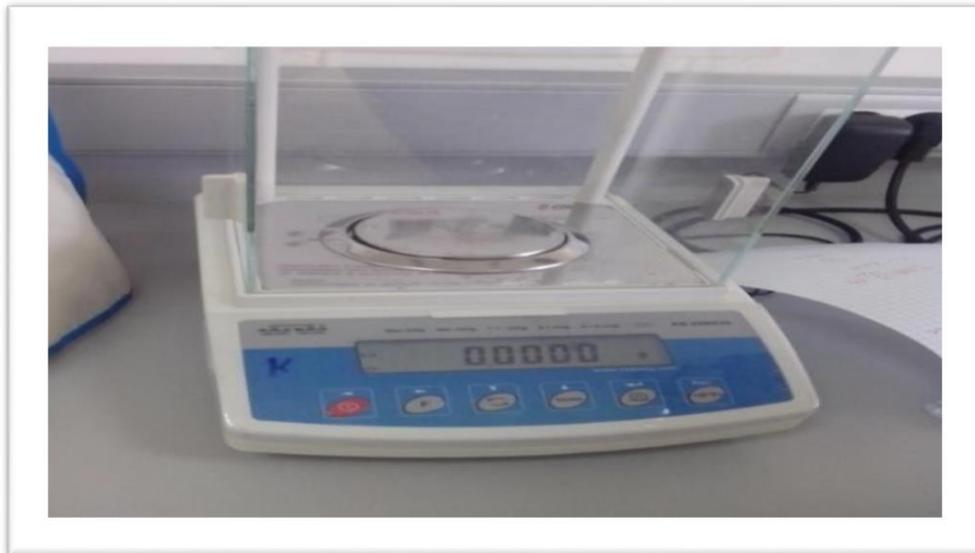
**Figure 3.7 : Photo de la balance analytique.**
