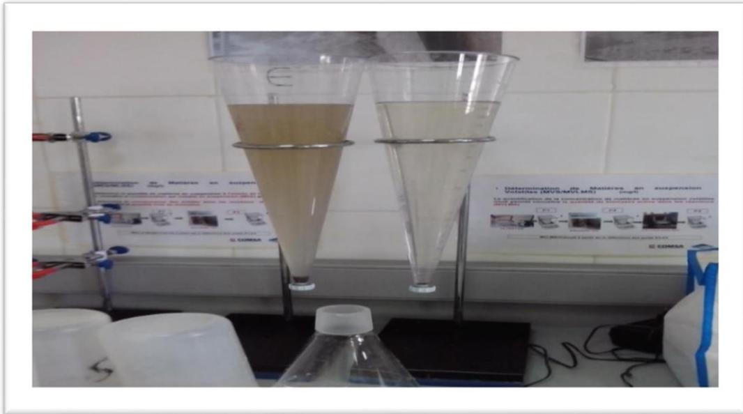
**Figure 3.14 : Test de décantation**
