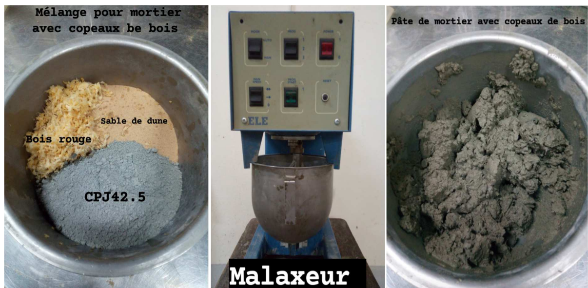
Figure II.22: Les étapes pour préparer la pâte de mortier avec différent pourcentage de copeau (sciure) de bois.
