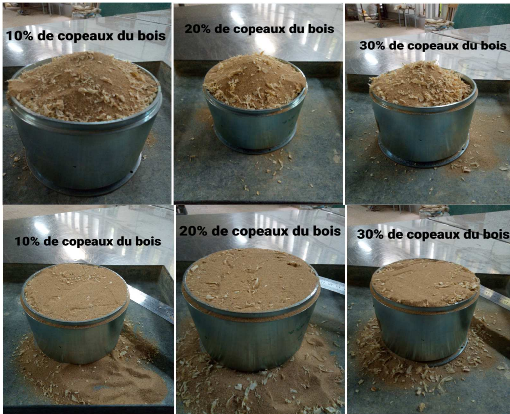
Figure II.14: Essais de la masse volumique apparente du mélange de sable de dune à différents pourcentages du copeau (sciures) de bois.
