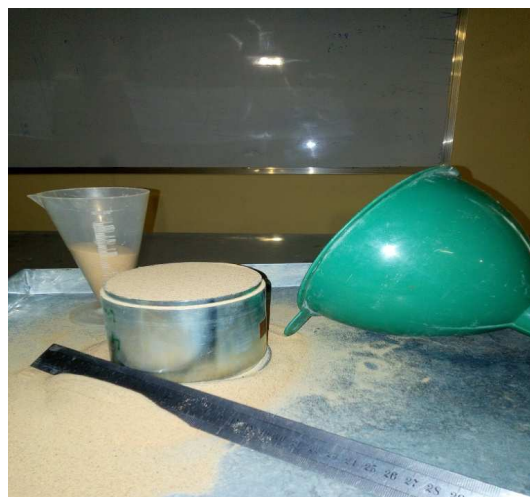
Figure II.4: Essais de la masse volumique apparente du sable utilisé.
