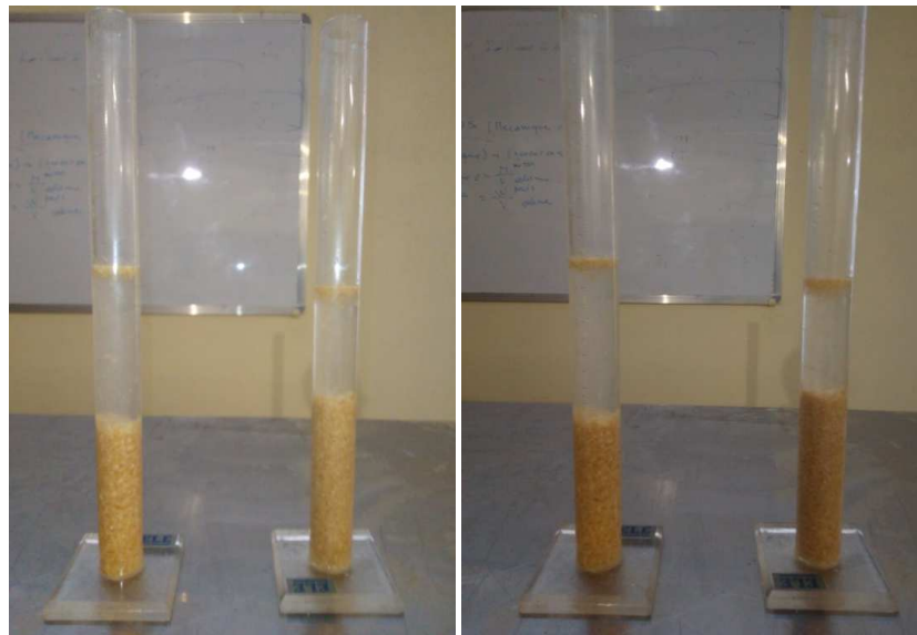
Figure II.10: Essai de la masse volumique absolue de la sciure de bois utilisées.
