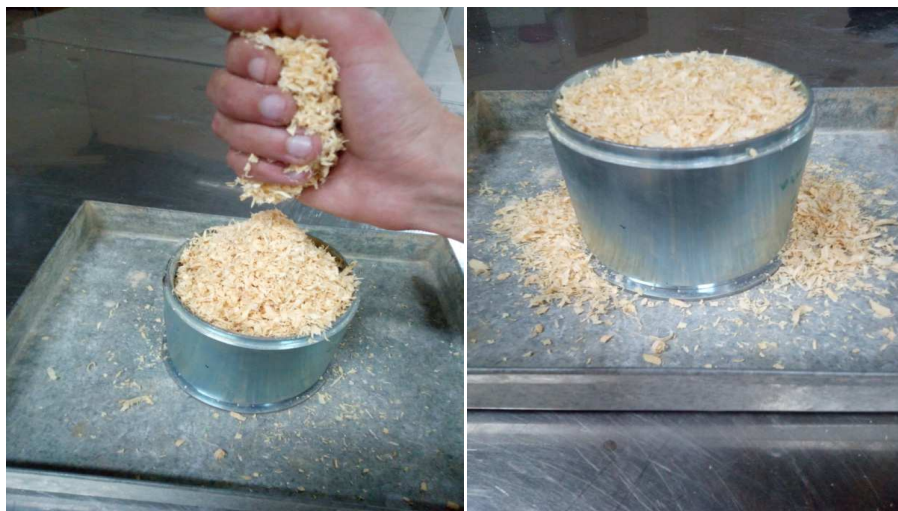
Figure II.9: Essais de la masse volumique apparente de la sciure de bois utilisées.
