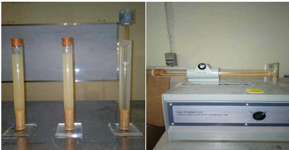
Figure II.6: Essai de l'équivalent du sable.
