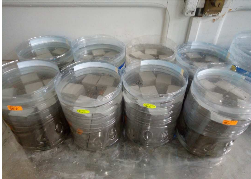
Figure II.27: Cure des éprouvettes à l'eau pendant 7 , 14 , 21 , et 28 jours.
