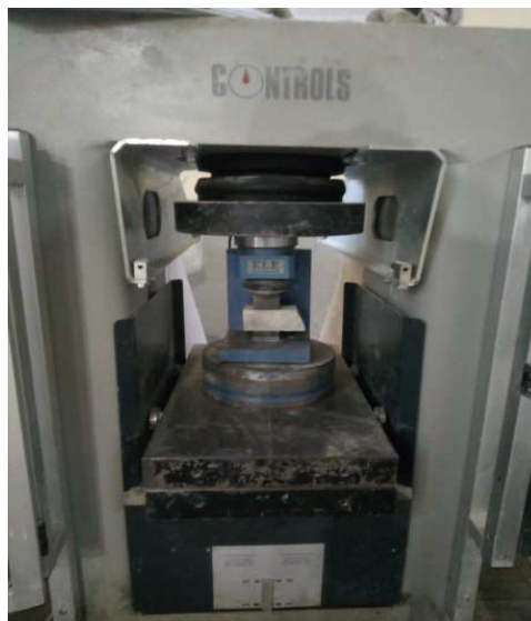
Figure II.32 : L'essai de résistance à la compression.
