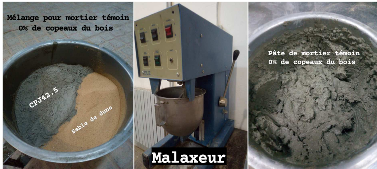
Figure II.21: Les étapes pour préparer la pâte de mortier témoin (0% sciure de bois).
