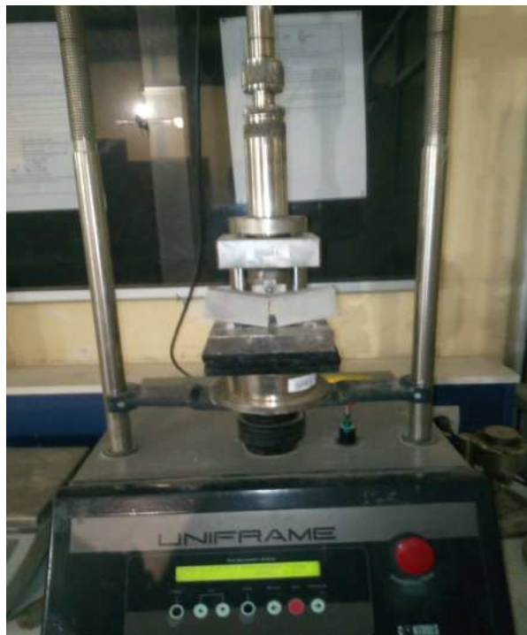
Figure II.30: L'essai de traction par flexion trois points.
