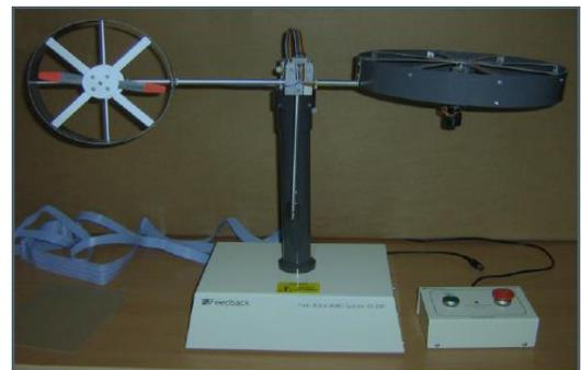
**Figure I.4 : le simulateur d'hélicoptère TRMS (Twin Rotor MIMO System)**
