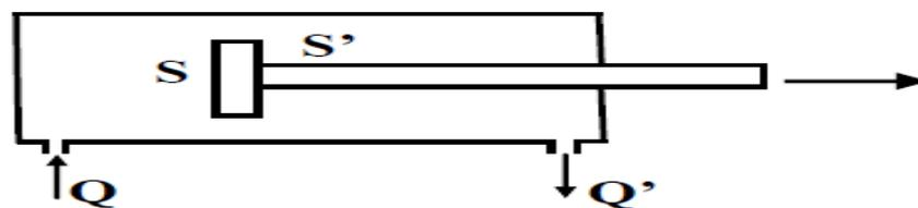
Figure 2.24 : Vitesse en sortie du vérin
