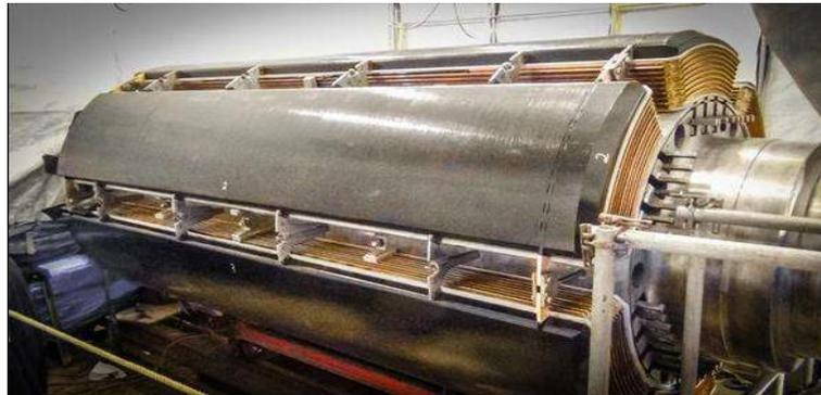
**Figure. I.3 :** Rotor à pôles saillants
