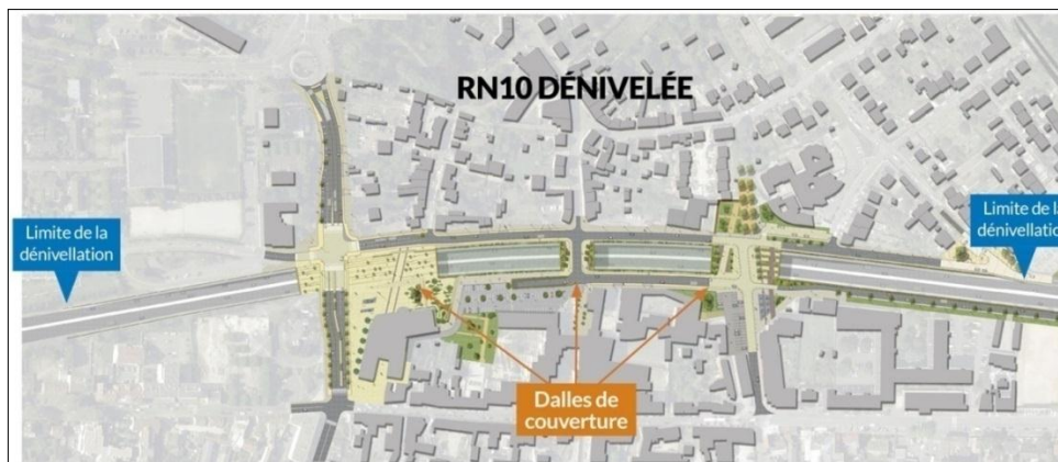
Figure10 : dénivellation et couverture de la RN10
