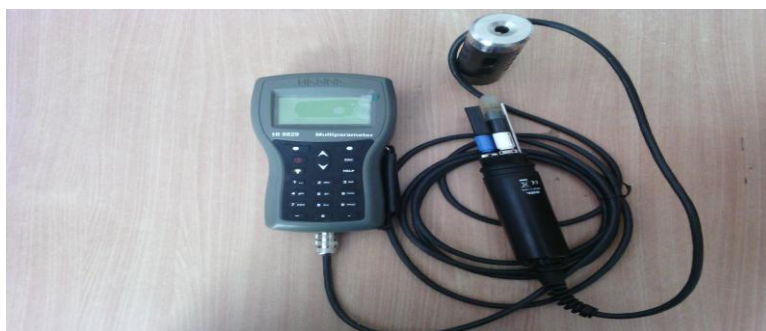
Figure 08. Muli paramètre (HANNA Hi 9829) [photo prise par Aliouche Sarra]
