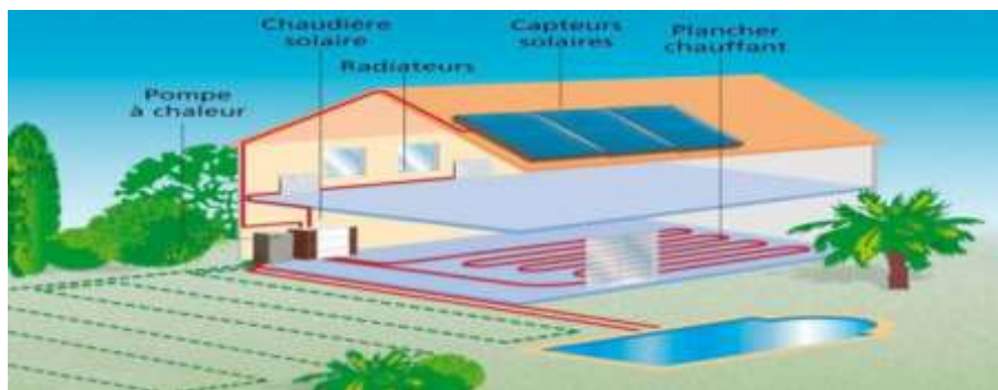
Figure 19 : Schéma de la maison zéro énergie. Source : Brigitte Vu, la maison à énergie zéro, Edition Eyrolles, deuxième tirage 2007 p 01.
