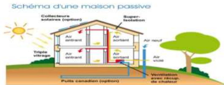
Figure 20 : Schéma de la maison passive. Source : http://capital-performance-energie.fr
