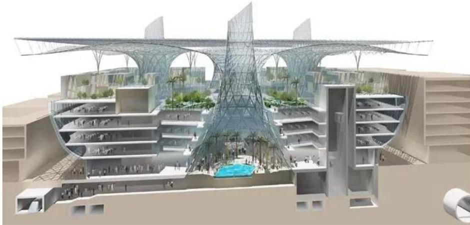
Figure 8 Le système de tour à vent moderne appliqué en Masdar city / source : [www.karbelmultimedia.com](http://www.karbelmultimedia.com)
