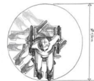
FIGURE 13 ESPACE DE MANŒUVRE D'UN FAUTEUIL ROULANT
