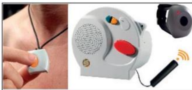
FIGURE 11 :ÉQUIPEMENT DE TELEALARME, MEDAILLON, BOITIER AVEC INTERPHONE ET DETECTEUR DE CHUTES
