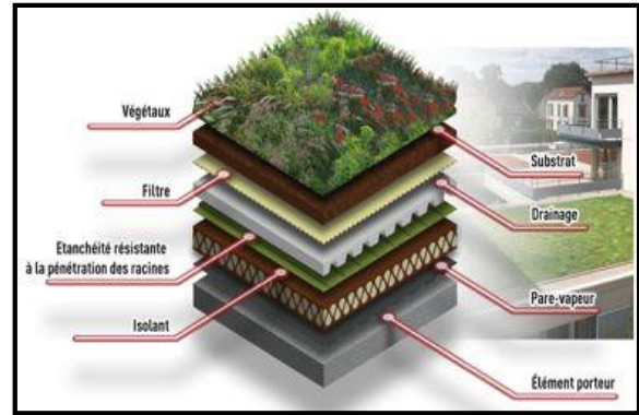
Figure 42: composition de toit végétalisé source : https://www.build-green.fr/vegetalisation-murs-toiture-
