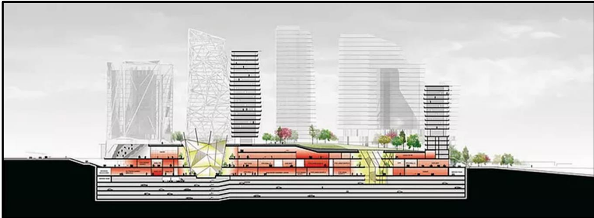
Figure 113: les puits Lumineux dans le centre commercial zorlu , source : https://v3.arkitera.com/tools/watermark.php?src=UserFiles/Image/ig/Yari_sma_Projeleri/zorlucenter/712.jpg
