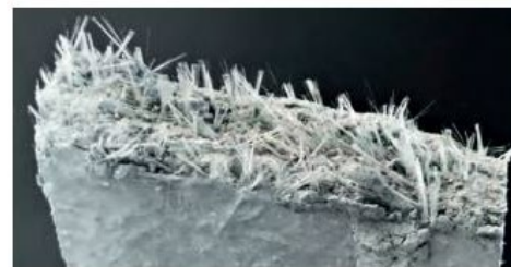
Figure 208 Renforcement de fibre dans le composite ciment-verre Source : www.constructalia.com
