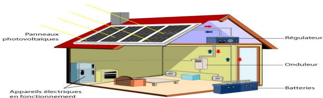
Figure 10: Énergie solaire photovoltaïque.
