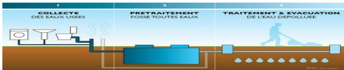
Figure 14: système autonome des traitements des eaux usées
