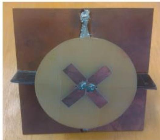
**Figure III.4:** Exemple d'une antenne dipôle croisée avec deux alimentations séparées.
