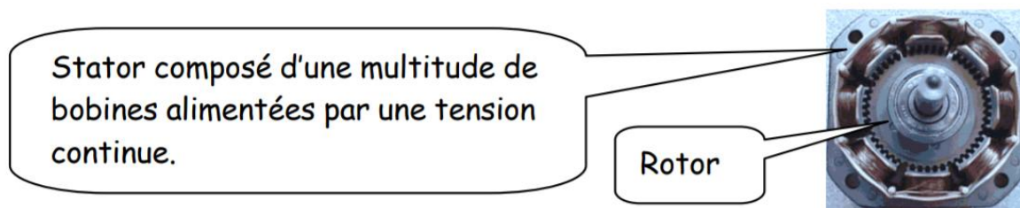
Figure 3.25 : Constitution d'un moteur pas à pas
