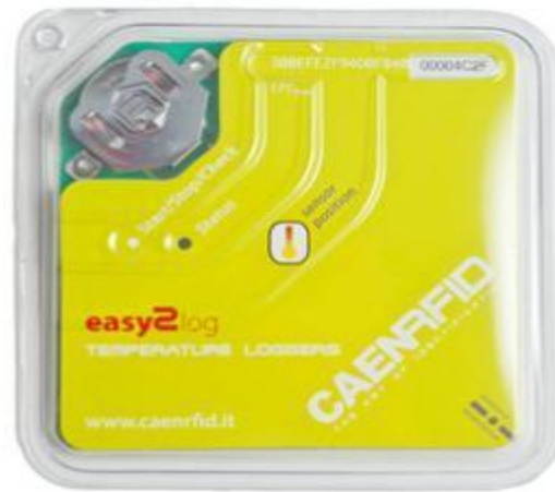
Figure I.6: RFID UHF avec Tag semi-passif.
