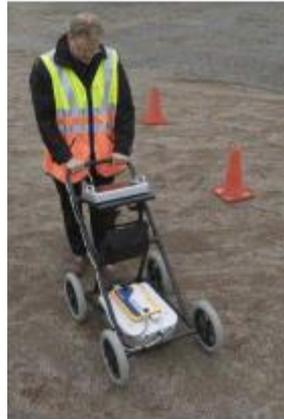
**Figure 1.12:** Radar RAMAC monté sur le chariot RAMAC GPR SCART.
