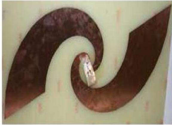
**Figure 2.10:** *Une antenne spirale.*
