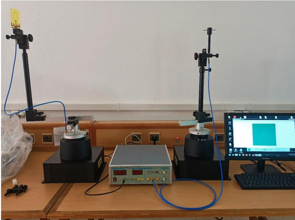
**Figure 3.11:** Banc de mesure de diagramme de rayonnement.
