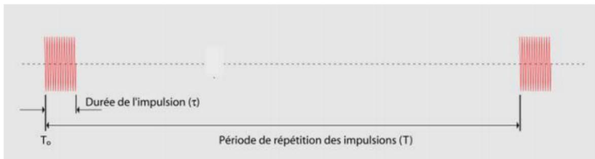
**Figure 1.3:** Signal émis par un radar impulsionnel.
