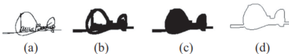
Figures 2.6 : Représentation des contours (a) Originale, (b) Dilatée, (c) Rempie, (d) Contour de la signature
