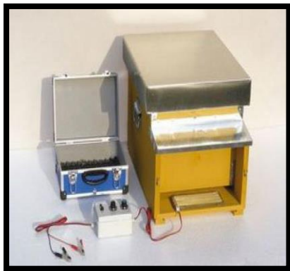
Figure 8: Collecteur électronique du venin d'abeilles [5].
