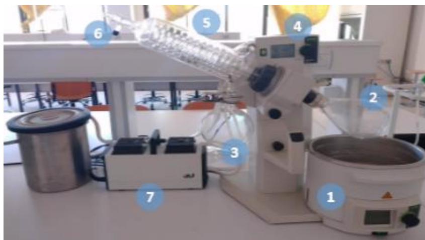
(1) bain thermostaté, (2)ballon d'évaporation, (3) ballon de réception, (4) régleur de la vitesse de rotation, (5) réfrigérateur, (6)robinet de mise sous vide, (7)Moteur.
