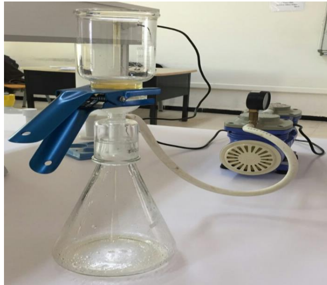
Figure 16 : Système de filtration.
