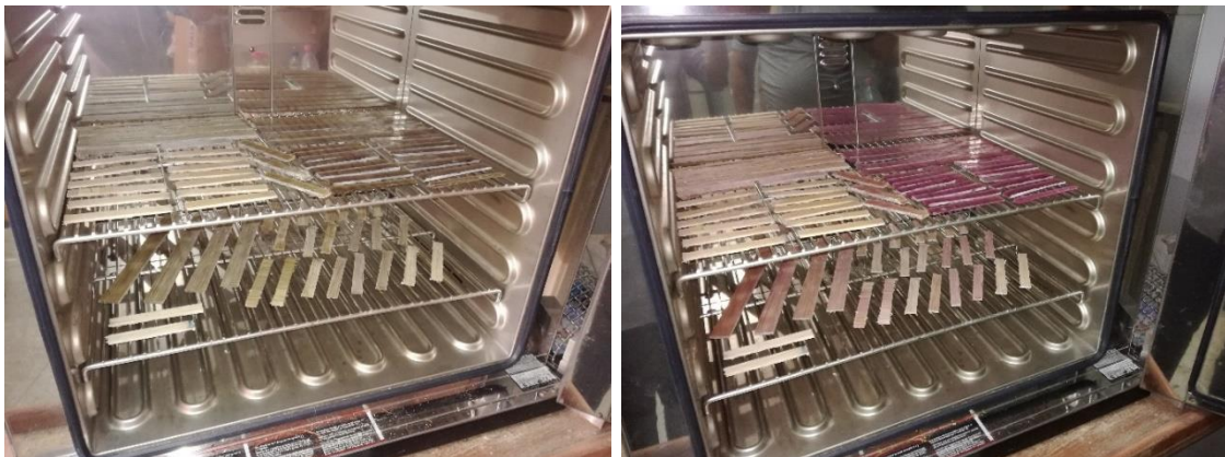
Figure II.7 Séchage des éprouvettes à une température de 70 °C dans une étuve.
