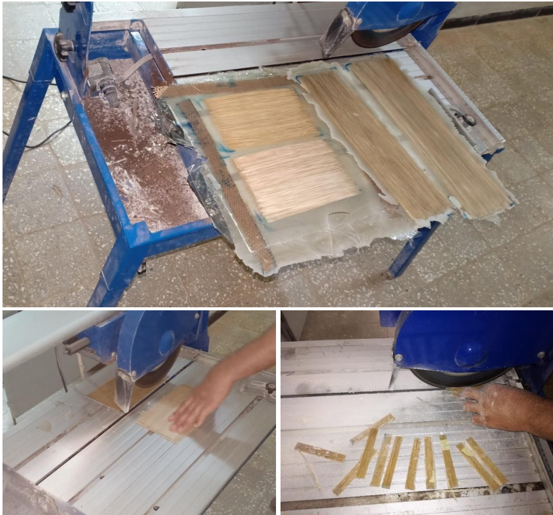
Figure II.6 Découpage des plaques biocomposites en éprouvettes utilisant une tronçonneuse à disque diamanté.
