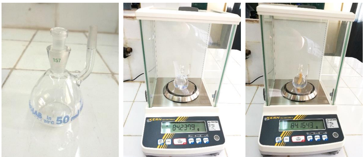
Figure II.11 (a) Pycnomètre (b) Balance avec le pycnomètre (c) Balance remplie avec fibres et eau distillée.
