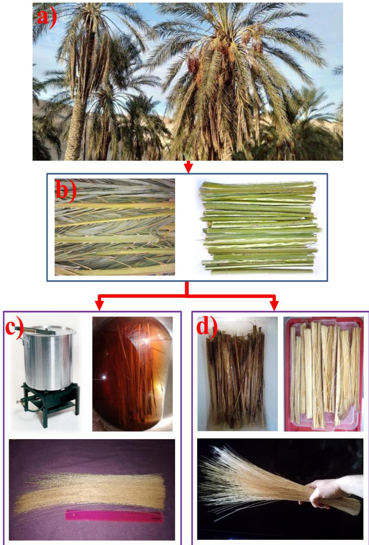
Figure II.1 Processus d'extraction des fibres de rachis des palmiers dattiers.
