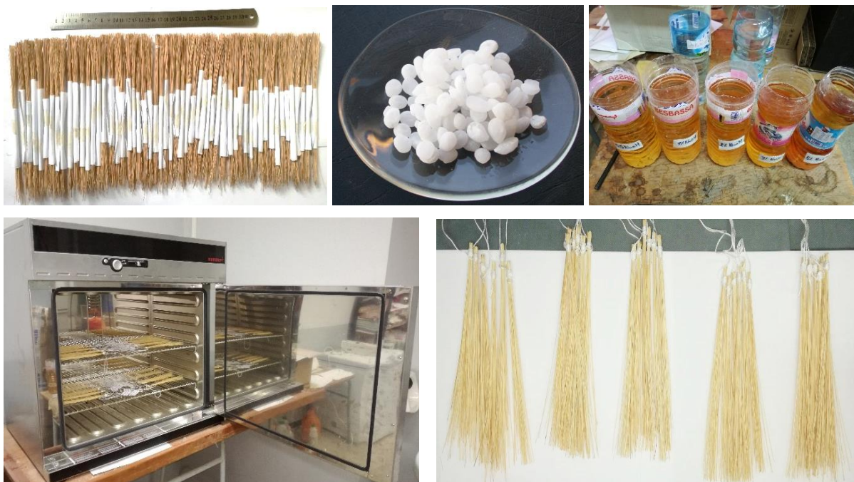
Figure II.2 Processus de traitement chimique des fibres de rachis des palmiers dattiers.
