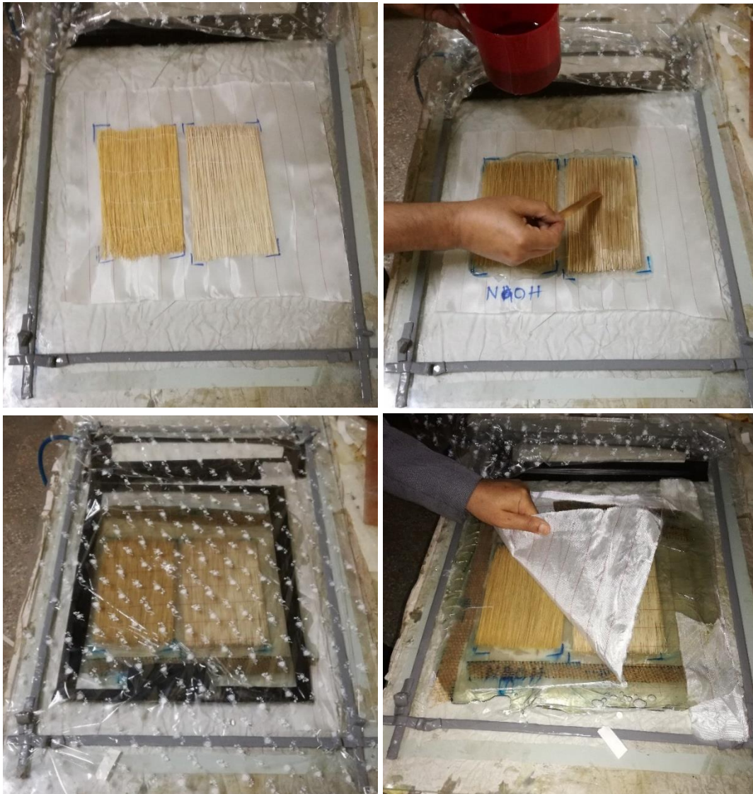
Figure II.5 Etapes de préparation des plaques biocomposites stratifiées par la technique du sac.
