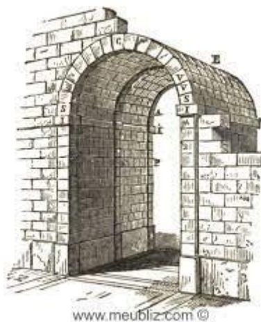
Figure 3-10 : Voûte en berceau
