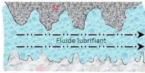
Figure I-4 : Frottement visqueux (vue microscopique)
