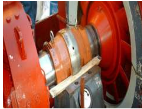
Fig.III-5 : Schémas d'un palier lisse et Photographie d'un paliers
