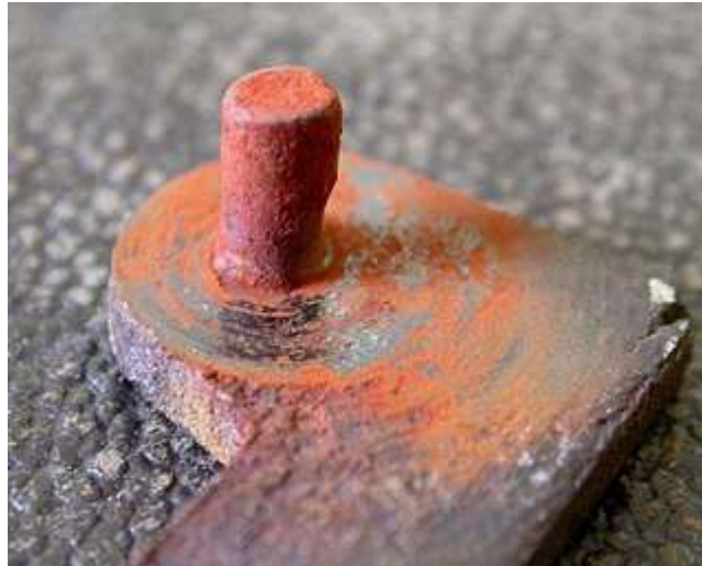
Figure I-8 : Conséquence de l'usure par corrosion.
