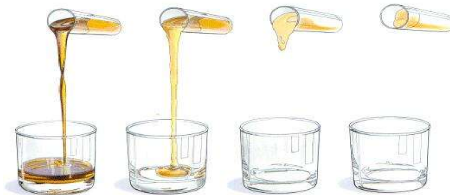
Fig. I-15: Viscosités des lubrifiants à l'aide d'un bidon d'huile
