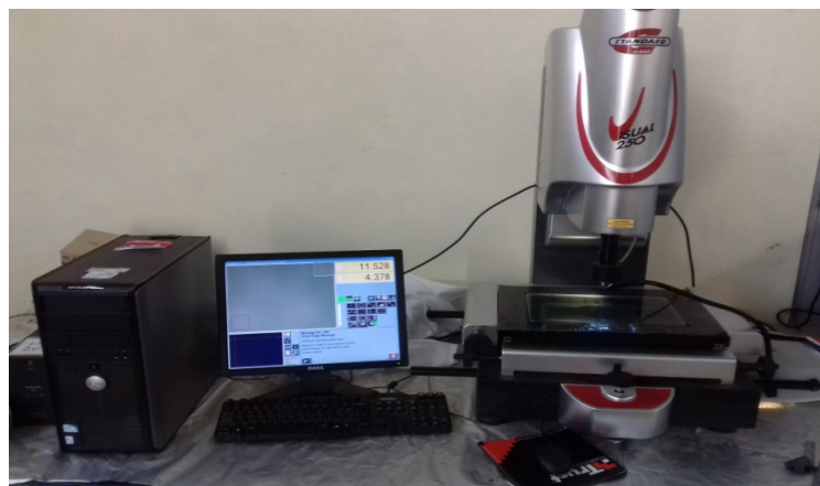
Figure II.12 Microscope pour la mesure de l'usure ( Visuel Gage 250 ).
