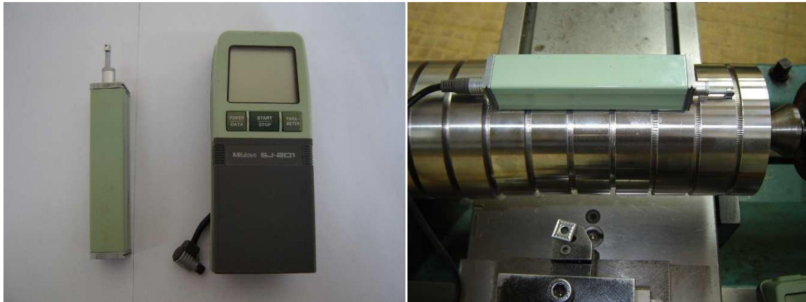
Figure II-9 : Mesure de rugosité sans démontage de la pièce.
