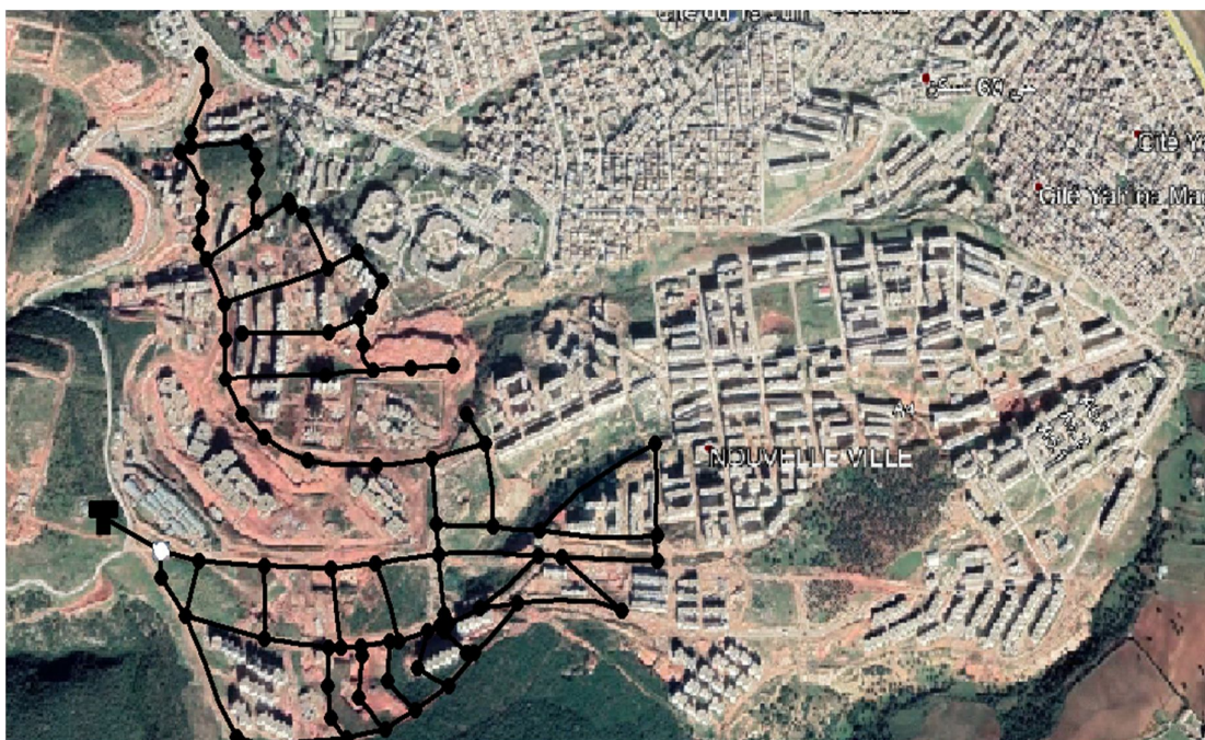
Figure 4.3 : Numérisation du Réseau AEP - Google Earth
