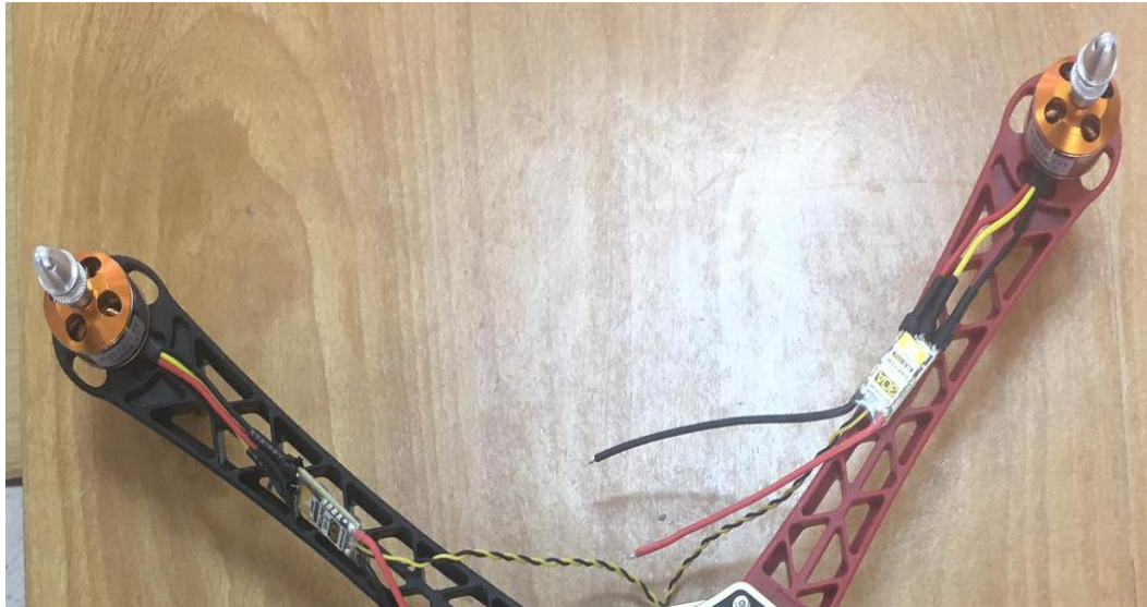
Figure (3-13): Montage du moteur sur le châssis
