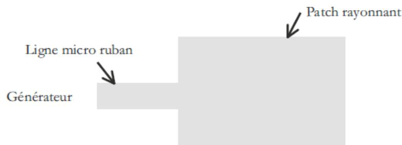
Figure III.4. Alimentation par ligne micro ruban
