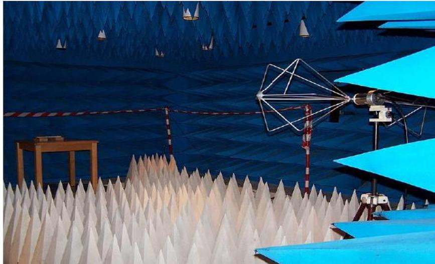
Figure I.11. Mesure des émissions rayonnées dans une chambre semi-anéchoïque
