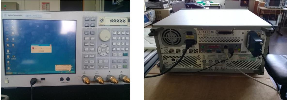
Figure II.3. analyseur de réseau Agilent E5071C
