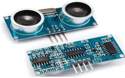
Figure II.6 : Capteur à ultrason vue de face et dos.[21]
