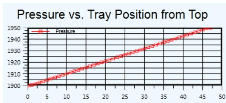
Figure IV.5 : Profil de pression en fonction du nombre de plateaux (cas design).
