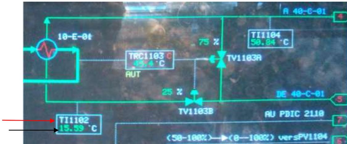
Figure IV.4 : Tableau synoptique de la salle de contrôle (DCS) de l'unité fractionnement GPL 400.
