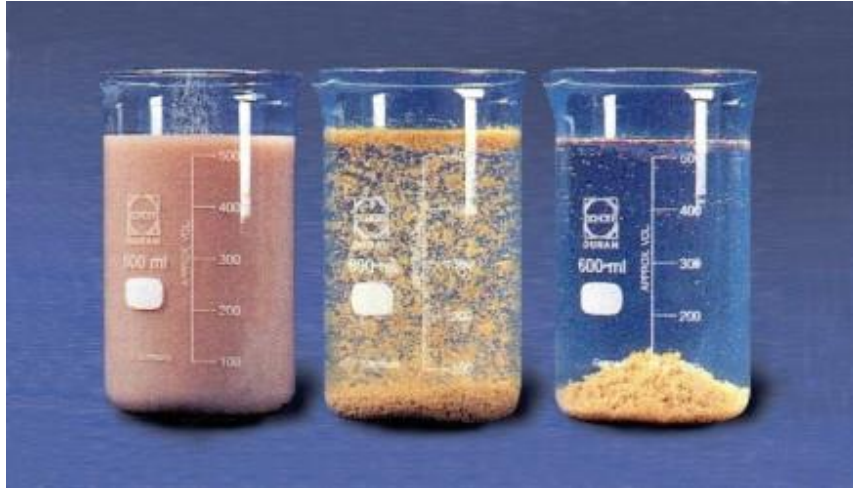
Figure 7 : La coagulation des colloïdes dans l'eau à l'aide d'aluminium.
