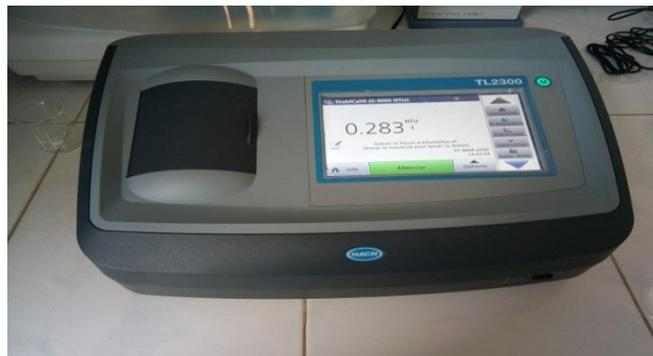
**Fig. IV.3.** Turbidimètre utilisé.
