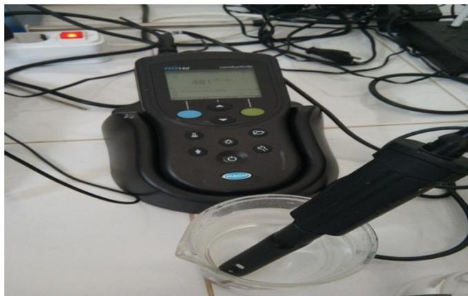
**Fig. IV.2.** Appareil de conductimètre utilisé.
