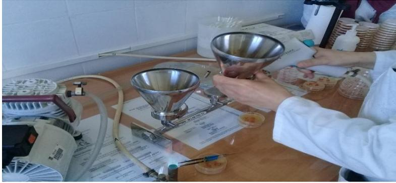
**Fig. IV.16.** Rampe de filtration.
