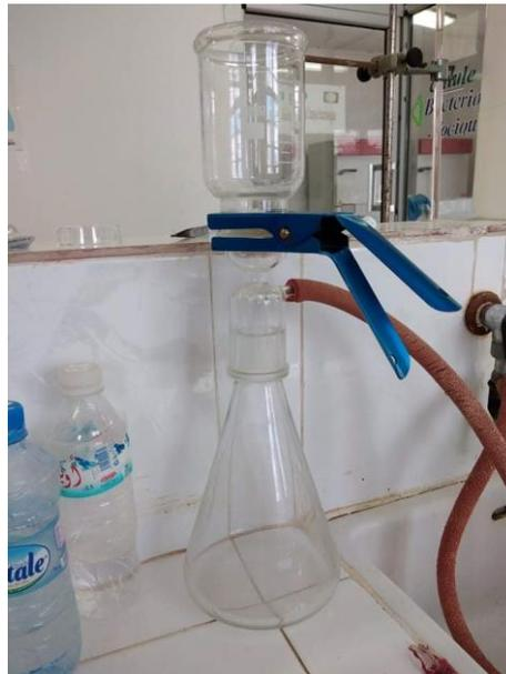
**Figure IV.7 :** Image représentant dispositif de filtration sous vide
