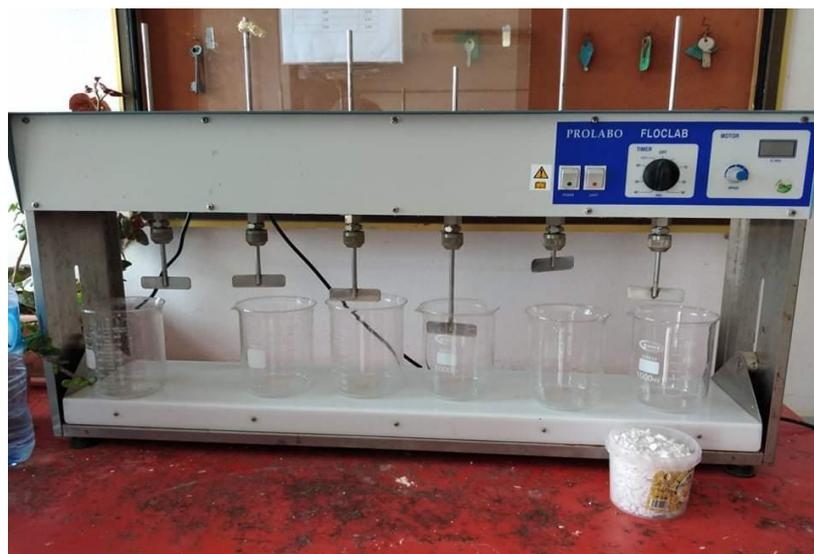
**Figure IV.13 :** Essai de coagulation-floculation « jar test »
