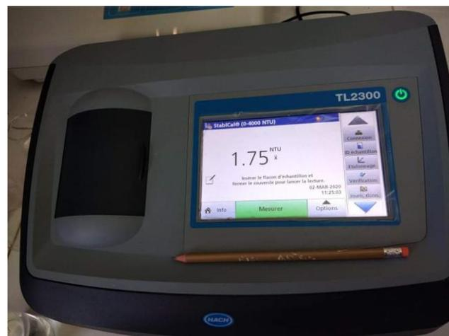
Figure IV.3 : Image d'un turbidimètre utilisé.
