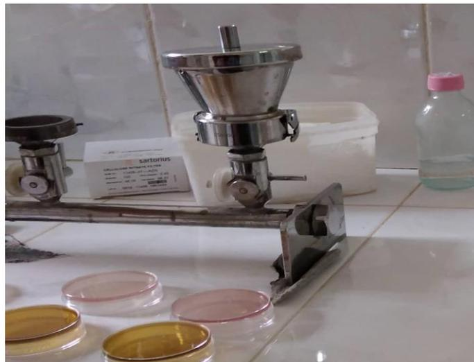
**Figure IV.9 :** la rampe de filtration
