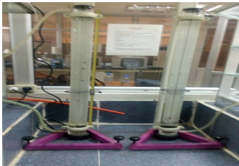
Figure III.5 : Appareillage des deux colonnes à gradient de densité [2].
