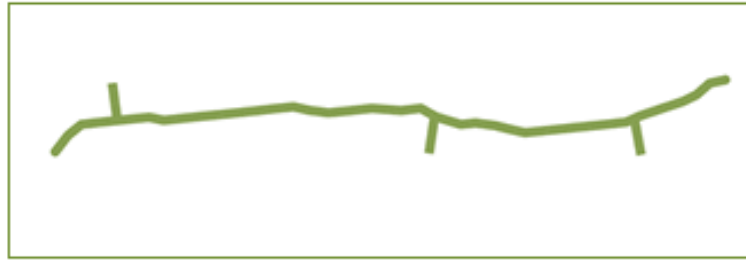
Figure.I.7 : Structure de polyéthylène haute densité PEHD [13].
