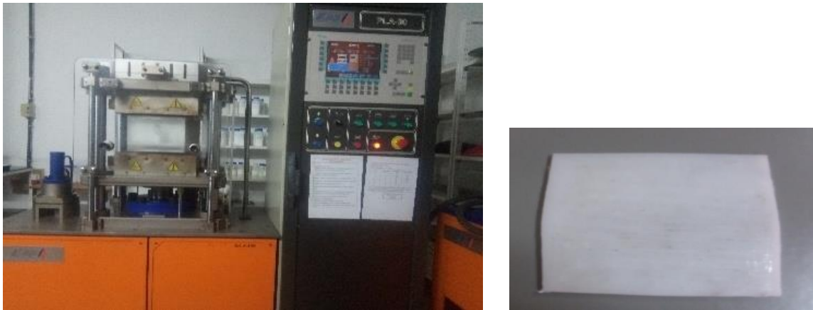
Figure III. 3 : Photo représentatif d'une presse hydraulique automatique et une Plaque de PEHD /SiO 2 [2].
