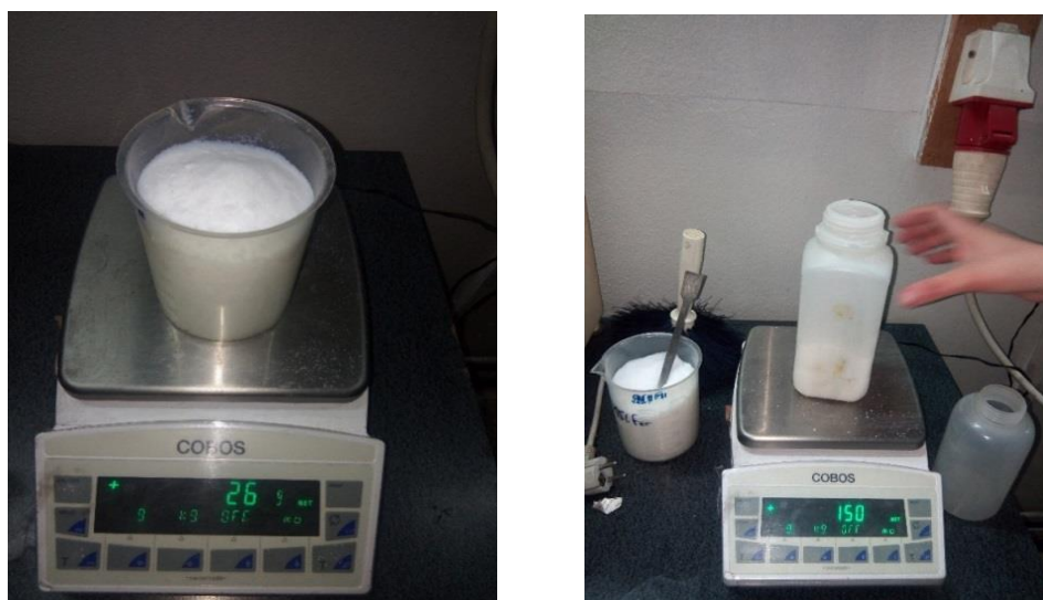
Figure III.1 : Différents pourcentages l'oxyde de silicium dans le PEHD [2].
