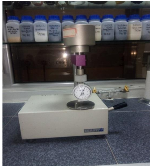
Figure III.6 : Appareillage de mesure de la dureté SHOR D [2].
