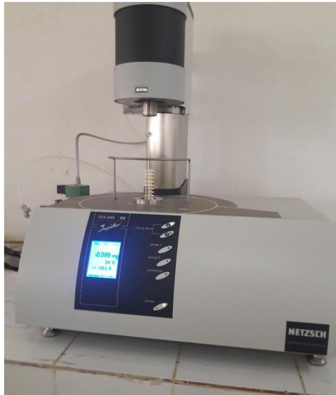
**Figure II.3 :** Appareil DSC type NETZSCH STA 449 F3 Jupiter : LSPN Guelma
