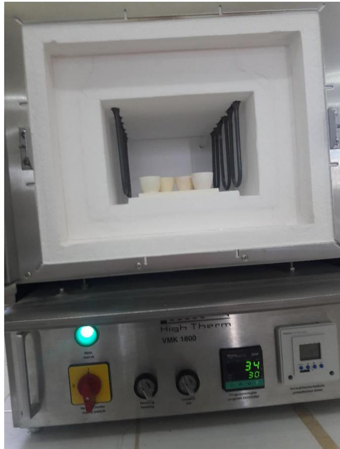
**Figure II.1** : Four électrique pour traitements thermiques type *Linn High Therm VMK 1800*
