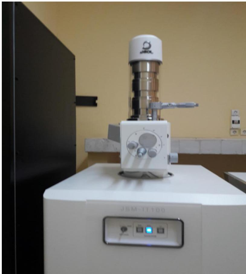
**Figure II.5** : Microscope électronique à balayage « JEOL JSM-IT100 : LSPN Guelma »
