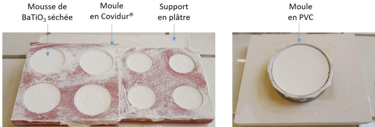
Figure II. 4 : Moules utilisés pour la mise en forme et le séchage des mousses de \text{BaTiO}_3 .
