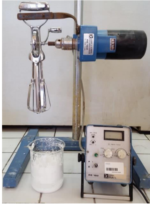
Figure II. 3: Battreur utilisé pour la transformation de la suspension en mousse.
