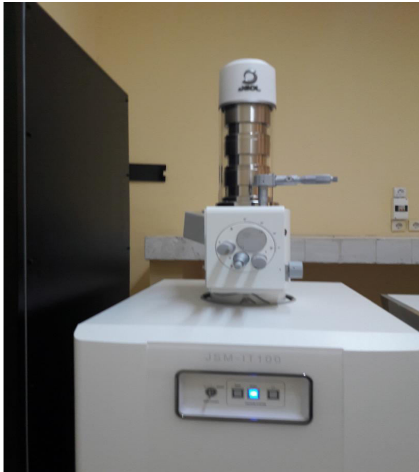
Figure II. 10: Microscope électronique à balayage « JEOL JSM-IT100 : LSPN Guelma »
