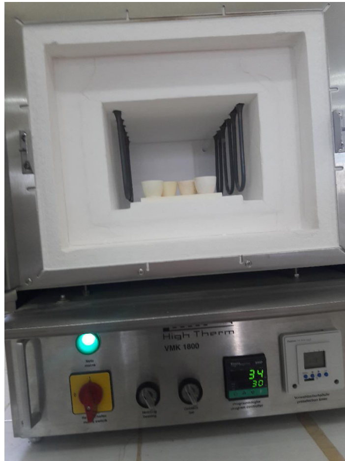
Figure II. 6: Four électrique pour traitements thermiques type Linn High Therm VMK 1800
