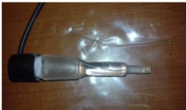
Figure III.3. L'électrode de référence Ag/AgCl utilisée dans les mesures électrochimiques.
