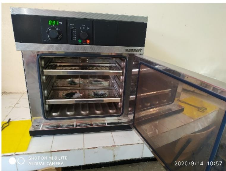
*Figure II. 6* : Photos de l'étuve utilisé pour le séchage.
