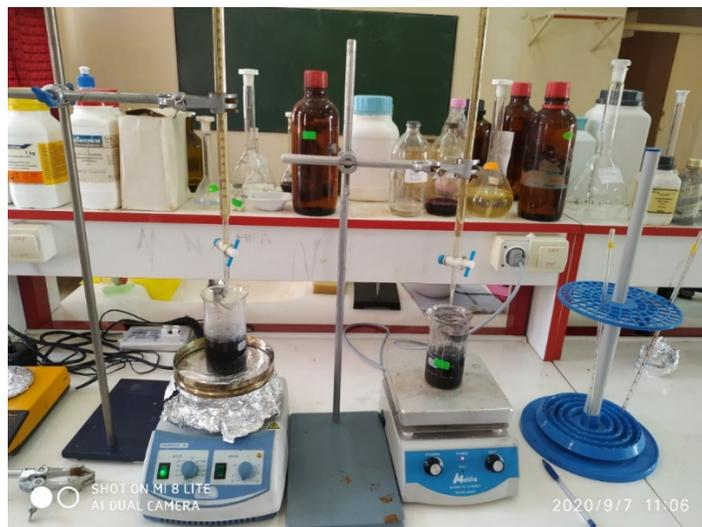
*Figure II. 4* : Montage de synthèse chimique des composites de graphène et d'OGr.
