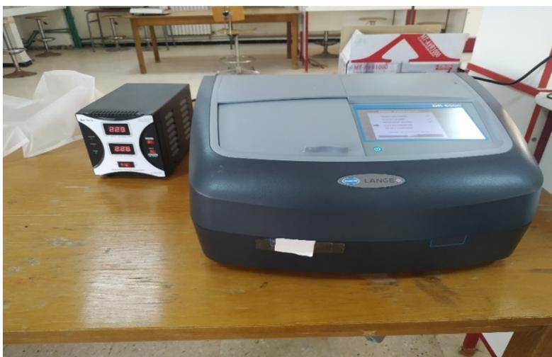
*Figure II. 13* : Spectromètre UV-Visible de type LANGE DR 6000.
