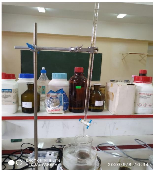
*Figure II. 3* : Montage de réduction de l'oxyde de graphène par l'hydrazine.
