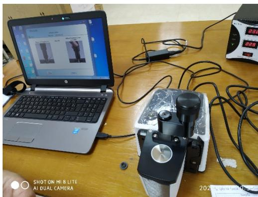
**Figure II. 9 :** Appareil de la spectroscopie infrarouge à transformée de Fourier (FTIR).
